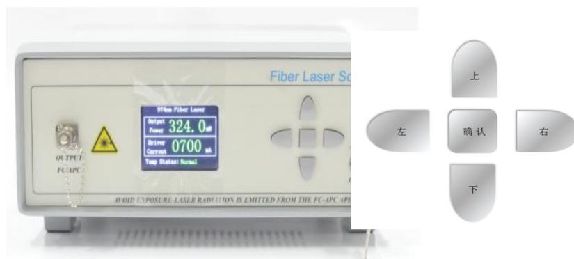
2. 液晶屏显示激光器波长、输出功率、温度监控状态。按下确认键，功率值出现红框，此时按左右键可以改变当前控制的位数；上下键可调节激光器驱动电流大小，调节后再次按下确认键，设置生效；对
