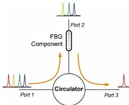
环行器通常结合光纤布拉格光栅从DWDM系统中分离光信道
