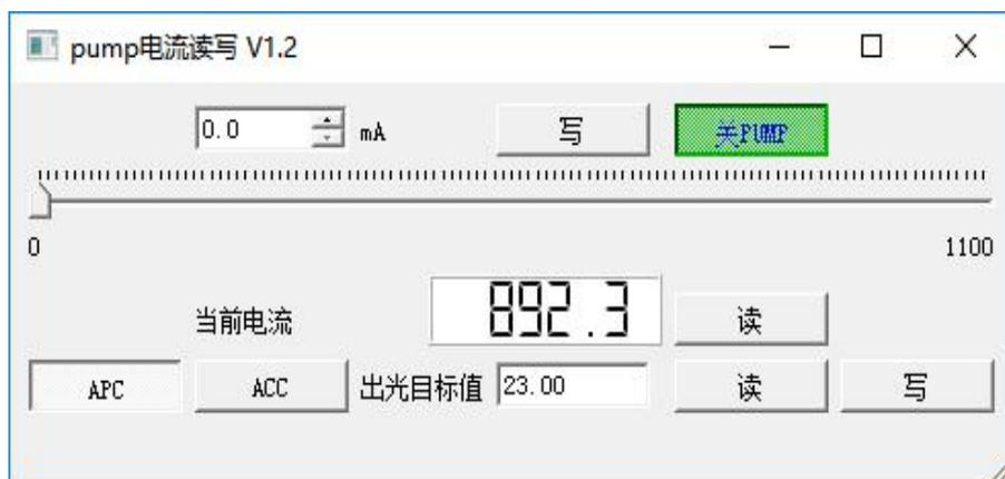
E、ACC 工作模式：选择 ACC 按钮，可通过电流刻度条或电流选择窗口调至目标电流值，点击“写”，然后点击“开 PUMP”按钮，模块开始工作，可通过“读”按钮，读取当前模块 pump 当前实际电流值，如下图：
