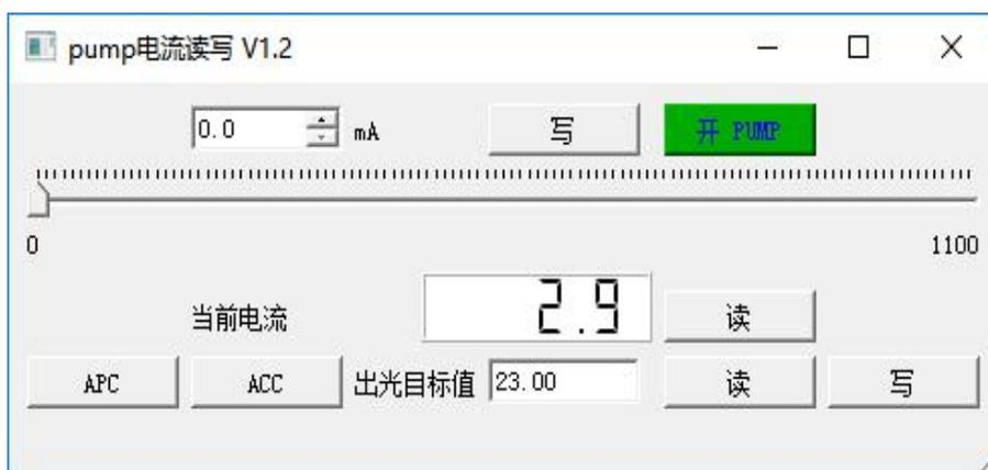
D、APC 工作模式：选择 APC 按钮，填写出光目标功率值，点击“写”，然后点击“开 PUMP”按钮，模块开始工作，如下图：
